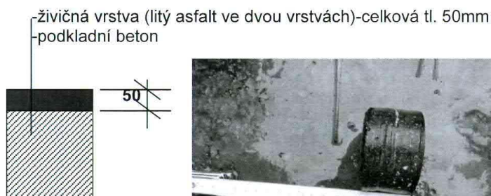
SCHEMA č.2 - Skladba podlahy ve vrtu V1
